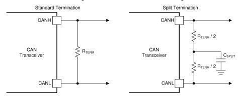
图 9-3. CAN Bus Termination Concepts
