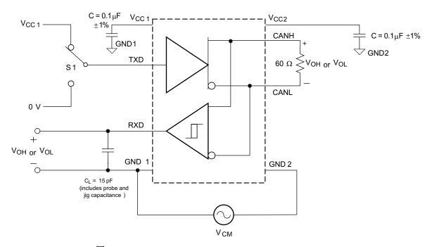
图 7-9. Common-Mode Transient Immunity Test Circuit
