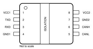
图 5-1. D Package 8-Pin SOIC Top View
