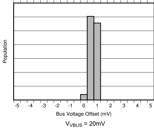
图 6-10. 总线输入失调电压产生分布图
