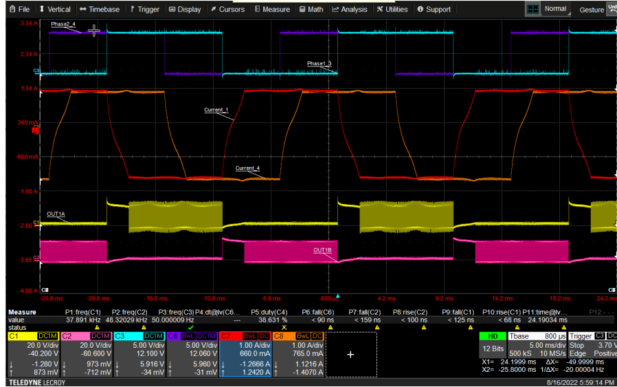
图 8-2. 以全步进模式驱动两个步进电机
