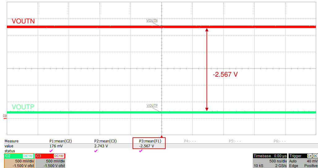
图 7-4. 典型的失效防护输出：AMC3311
