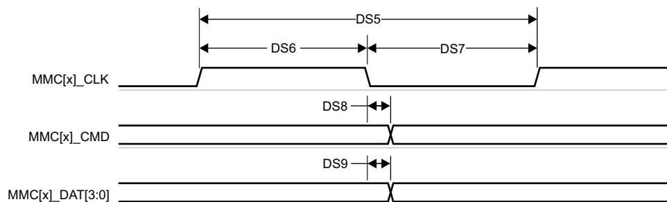
图 7-84. MMC1/MMC2 - Default Speed - Transmit Mode
