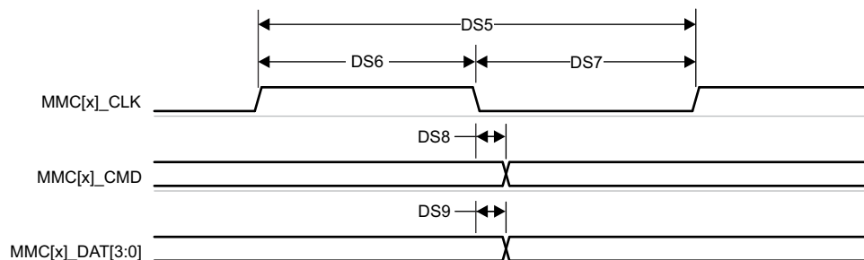
图 7-73. MMC0 - Default Speed - Transmit Mode
