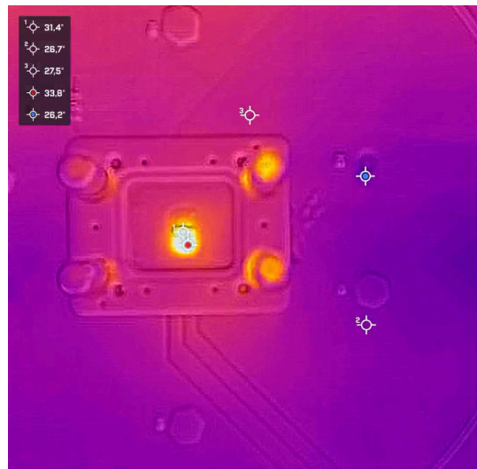
图 2-6. AMC038x 热结果：12.5M Ω
