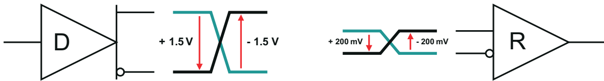
图 4-1. RS-485 规定的最低总线信号电平
