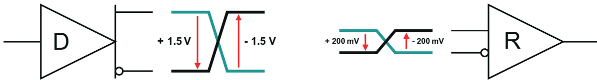
图 4-1. RS-485 规定的最低总线信号电平
