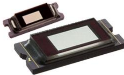
图 5. 0.2" 对角线 DMD（例如 DLP2010）与 0.45" 对角线 DMD（例如 DLP4501）的对比
