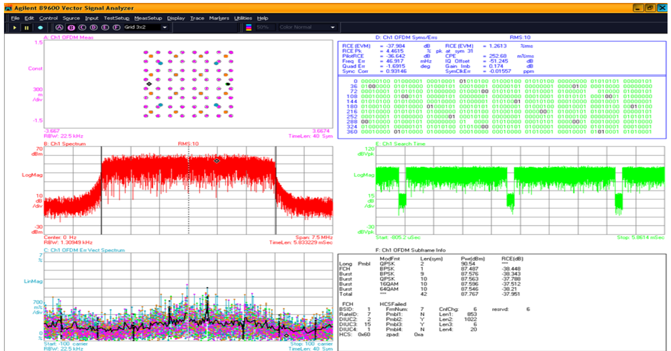
图十二 20MHz OFDM 测试结果
