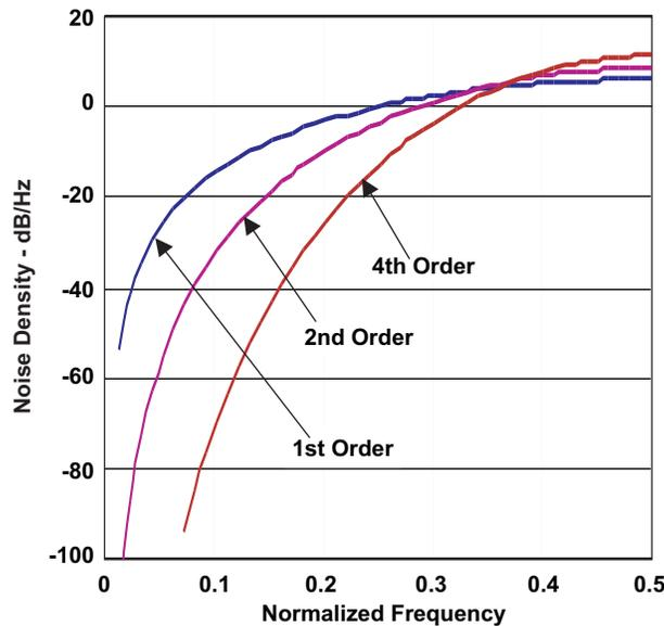
Figure 2. ADS1255 Modulator Noise
