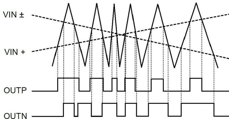
**Figure 3. Spread-Spectrum Mode Modulation**
