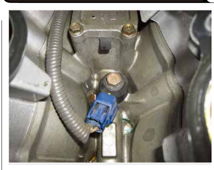
图 1: 安装在发动机缸体上的爆震传感器
