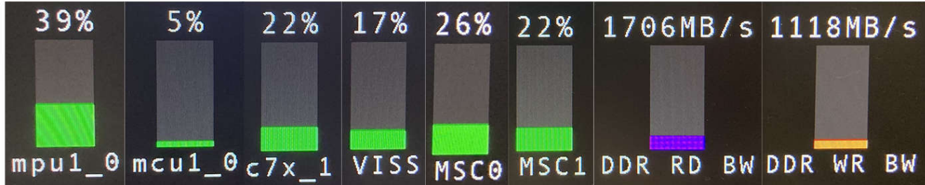
图 5-2. 使用 tiperoverlay gstreamer 插件的缺陷检测演示底部显示的内核负载条形图（该图经过编辑以适合页面）
