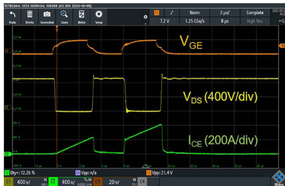
图 5-5. 使用 5.5\ \Omega 栅极电阻器的弱驱动
