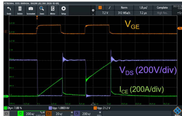
图 5-6. 使用 0.5\ \Omega 栅极电阻器的强驱动
