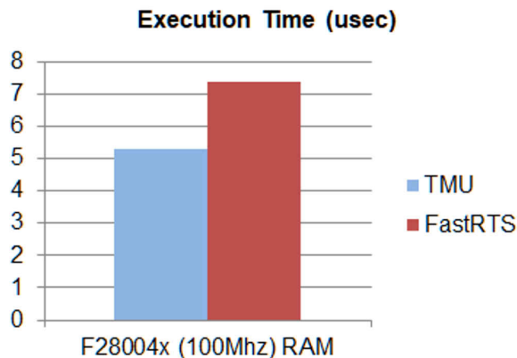
图 3-4. 使用 TMU 和 FastRTS 在 RAM 上的控制环执行时间
