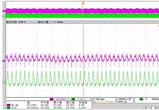
Figure 19. 115-V AC 60-HZ Input, 15-V, 2.5-A Output
