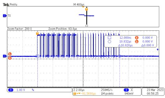
Figure 3-1. 64 Bytes Transmit Time
