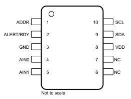
Figure 4-1. Pin Diagram (VSSOP) Package
