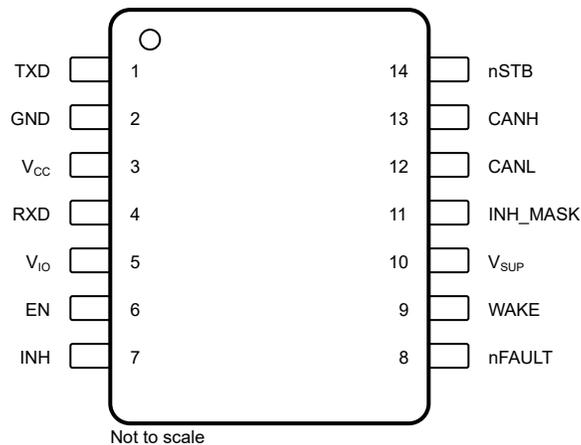
**Figure 4-1. TCAN1463-Q1 SOIC/SOT Pin Diagram**
