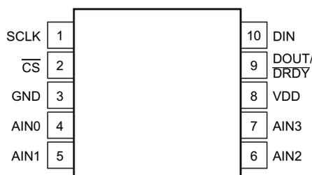
**Figure 2. Pin Diagram**
