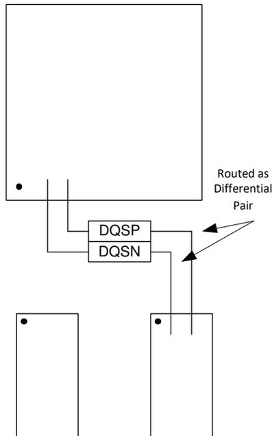
**Figure 2-11. DQS Routing to Two DDR4 SDRAM Devices**
