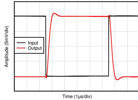
$C_L = 20\text{pF}$ ,  $G = -1$ , 20mV ステップ応答
