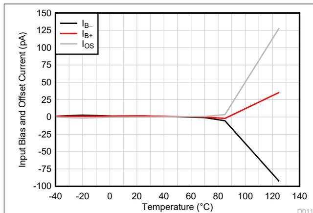
図 5-13. 入力バイアス電流と温度との関係
