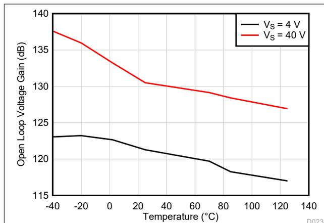
図 5-25. 開ループ電圧ゲインと温度との関係 (dB)
