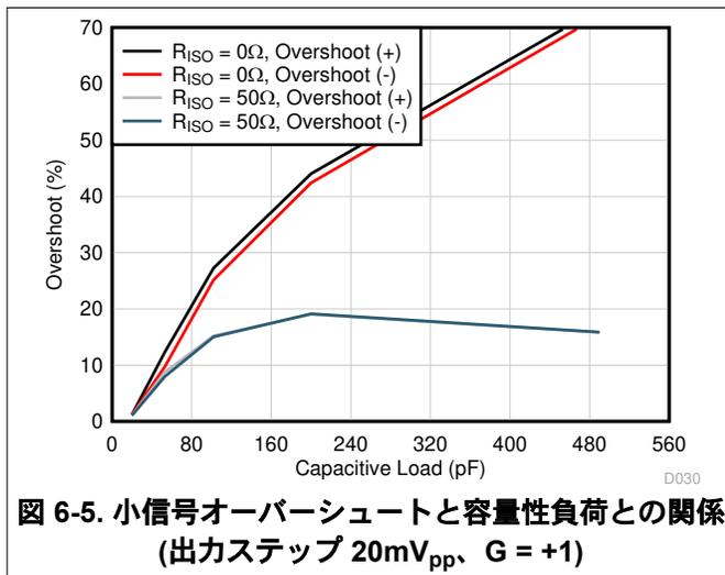
図 6-5. 小信号オーバーシュートと容量性負荷との関係 (出力ステップ 20mV<sub>pp</sub>、G = +1)
