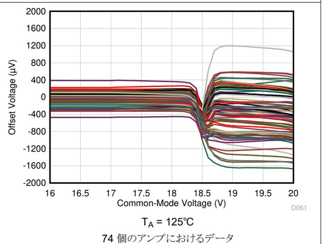
図 5-8. オフセット電圧と同相電圧との関係 (遷移領域)
