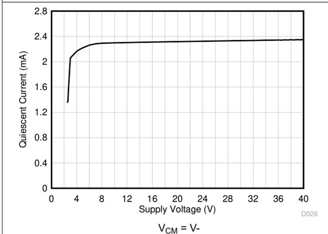
図 5-27. 静止電流と電源電圧との関係
