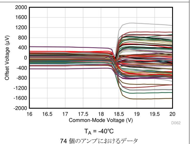
図 5-10. オフセット電圧と同相電圧との関係 (遷移領域)
