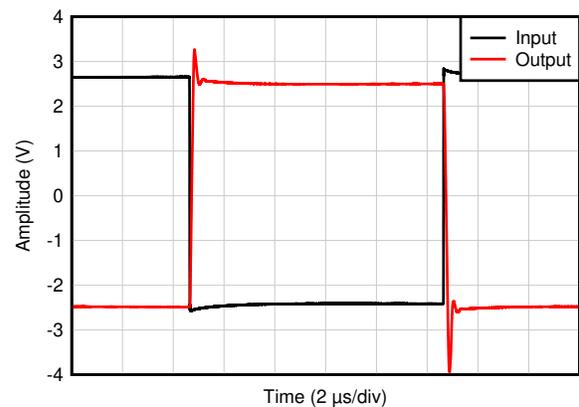
$C_L = 20\text{pF}$ ,  $G = -1$ ,  $5\text{V}_{pp}$  ステップ応答
