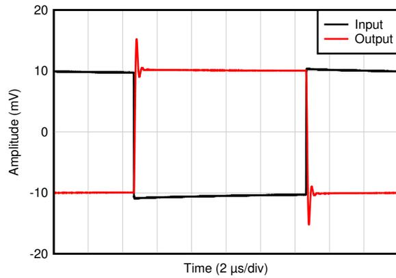
$C_L = 20\text{pF}$ ,  $G = -1$ ,  $20\text{mV}_{pp}$  ステップ応答
