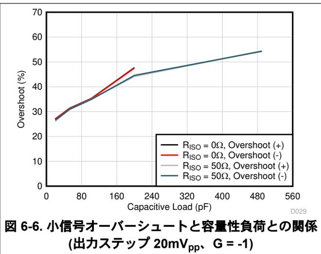
図 6-6. 小信号オーバーシュートと容量性負荷との関係 (出力ステップ 20mV<sub>pp</sub>、G = -1)
