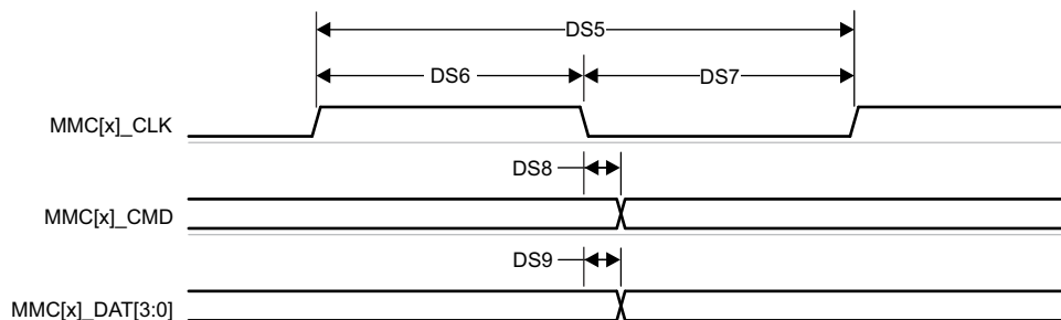
図 6-77. MMC1/MMC2 – Default Speed – Transmit Mode
