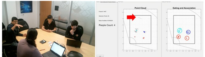
图6. 会议室内有许多静态物体，这些物体可能会导致传统的传感器出现误检。TI 毫米波传感器上的静态干扰消除算法可以忽略桌椅等静态物体及墙上的反射影像（如红色箭头处所示）。
