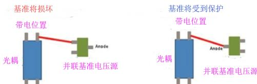
图 4：电弧（红线）对并联基准的影响。
