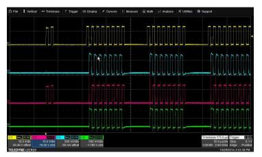
Figure 27. UCC28950 Burst-Mode Function
