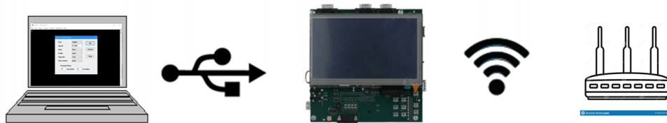
图 5-1. Wi-Fi 基站硬件设置
