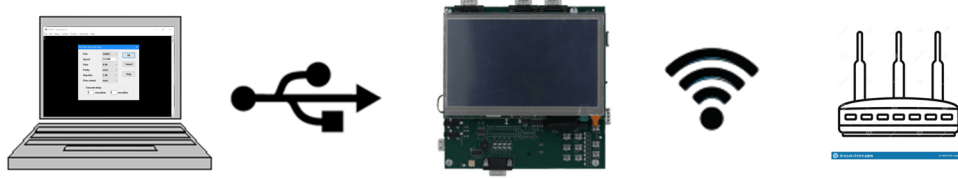
图 4-1. 为驱动程序启动采用 AM335x 和 WiLink8 的基本硬件设置
