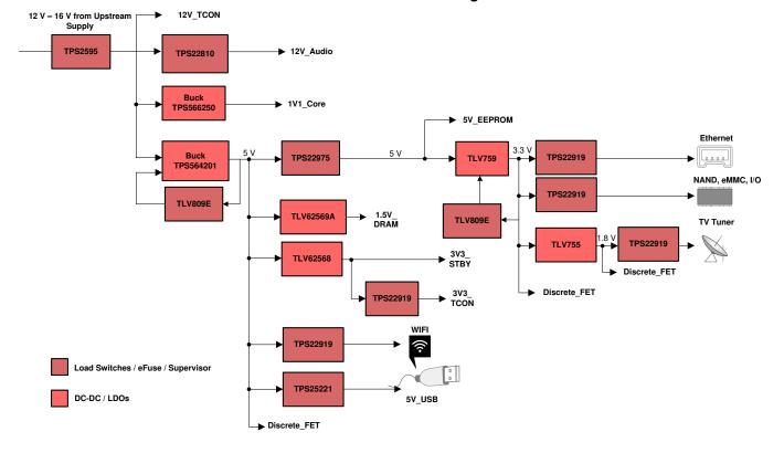
图 1. TIDA-050027 Block Diagram
