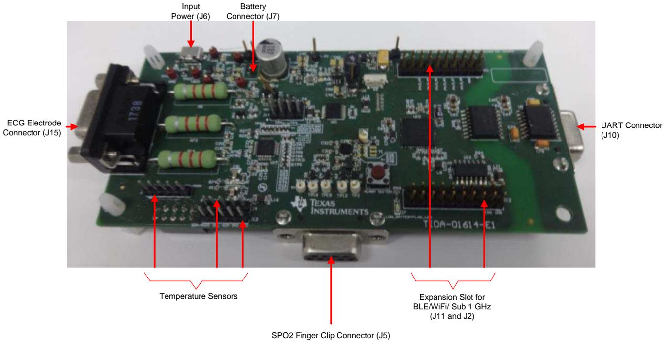
图 22. TIDA-01614 PCB 连接器配置 – 底部视图
