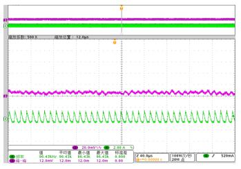
图 16. 115-V AC, 60-Hz Input, 5-V, 5-A Output
