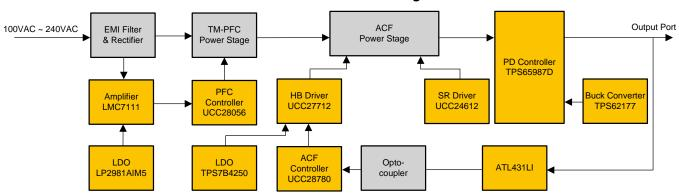
图 1. TIDA-010047 Block Diagram
