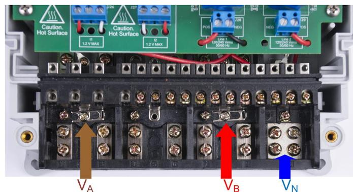
图 20 显示了从正面视图的连接。V<sub>A</sub> 和 V<sub>B</sub> 对应于 A 相和 B 相的线路。V<sub>N</sub> 对应于来自测试 AC 源的零电压。I<sub>A+</sub> 和 I<sub>A-</sub> 对应于 A 相的电流输入，而 I<sub>B+</sub> 和 I<sub>B-</sub> 对应于 B 相的电流输入。
