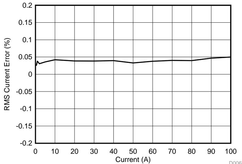
**表 17. Phase B RMS Current % Error, Two-Voltage Mode**
