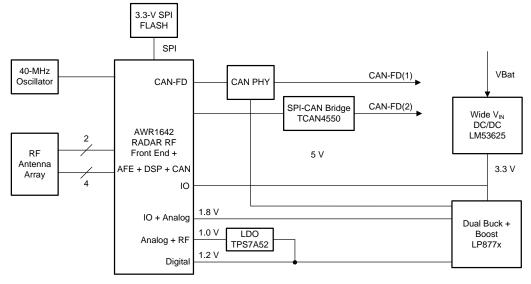
图 1. Radar Module Block Diagram
