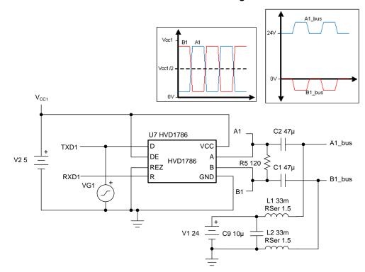
图 1. TIDA-010035 Block Diagram
