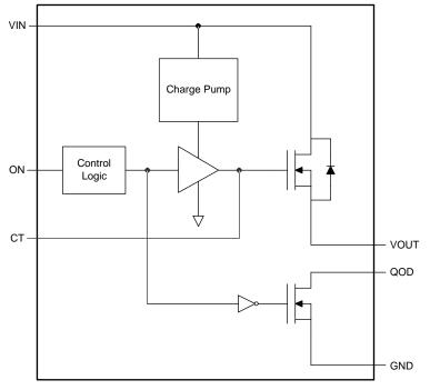
图 4. TPS22918-Q1 Functional Block Diagram
