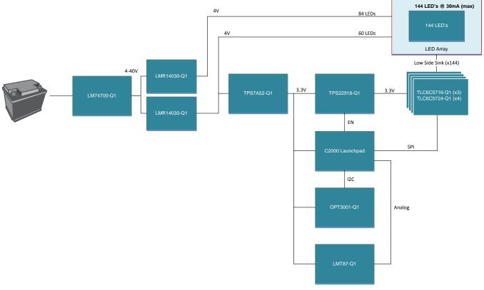
图 1. TIDA-020001 Block Diagram
