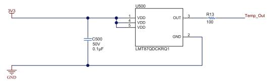
图 12. TIDA-020001 Temperature Sensor
