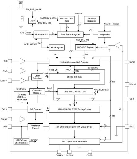
图 3. TLC6C57xx-Q1 Functional Block Diagram
