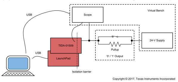
图 13. Test Setup of TIDA-01509
