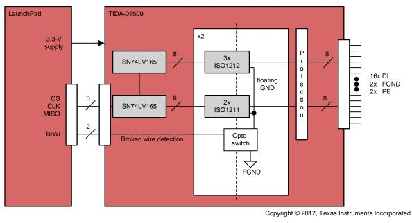
图 1. Block Diagram of TIDA-01509
