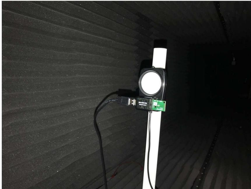
**图 31. TIDA-01008 Light Meter and OPT3001 EVM Test Setup**
