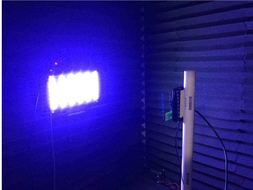
图 30. TIDA-01008 Illuminance Sensing Testing
