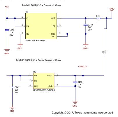
图 15. LP5912-Q1 and LP5907-Q1 Circuits
