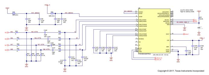
图 17. PCM1865-Q1 Circuits—Slave PCM1865-Q1
