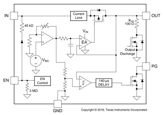
图 6. LP5912-Q1 Functional Block Diagram
