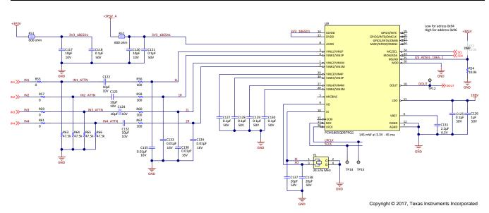
图 16. PCM1865-Q1 Circuits—Master PCM1865-Q1
