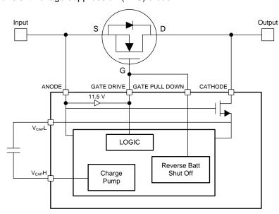
图 7. LM74610-Q1 Functional Block Diagram
