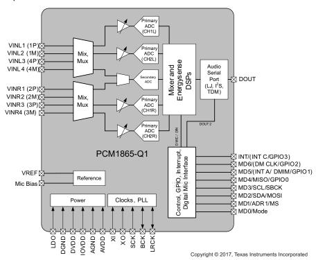
图 4. PCM1865-Q1 Simplified Block Diagram
