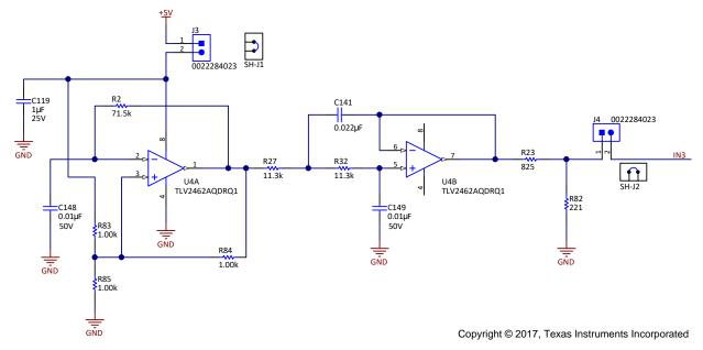
图 21. TLV2462-Q1 Oscillator Circuit
