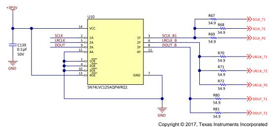
图 18. SN74LVC125A-Q1 Circuit
