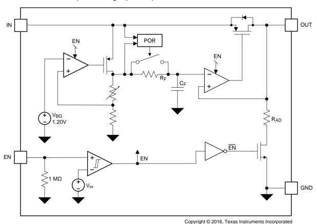
图 5. LP5907-Q1 Functional Block Diagram
