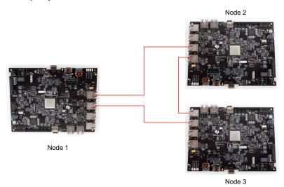
图 9. Three-Node Network Setup
