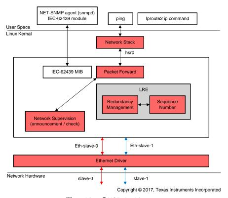
图 10. Linux<sup>®</sup> HSR Architecture
