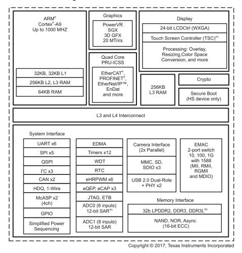
图 5. AM437x Block Diagram
