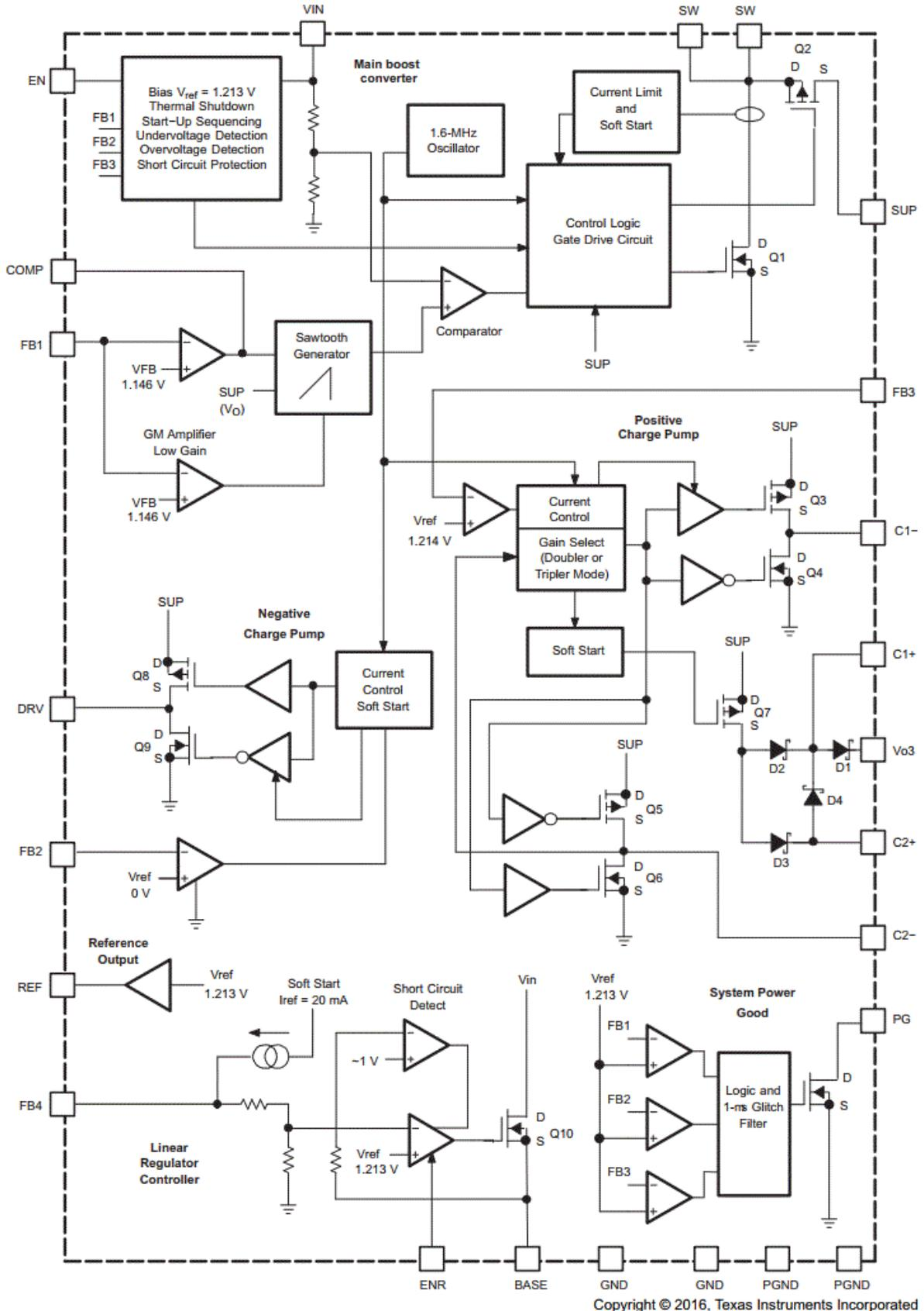
图 5. TPS65145 Block Diagram
