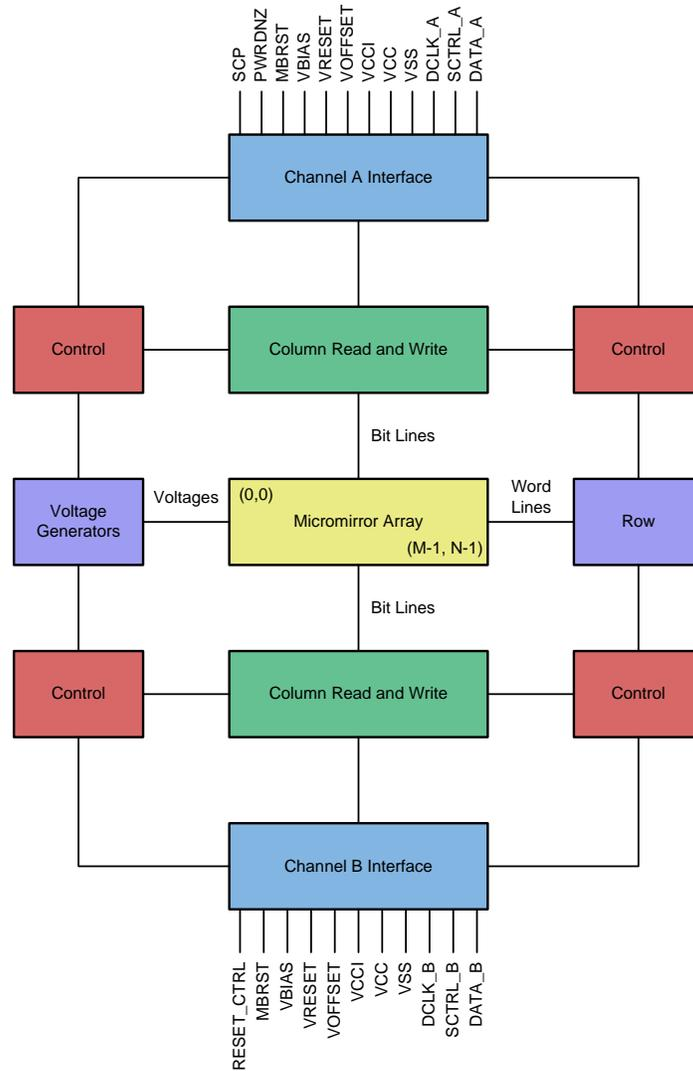
图 2. DLP470NE Block Diagram
