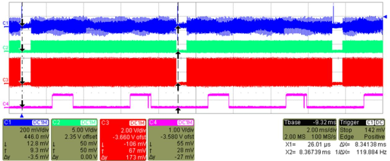
图 17. 120-Hz Frame Rate Measurement
