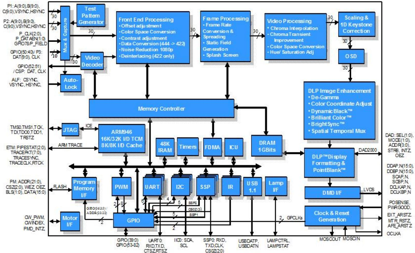
图 3. DLPC4422 Block Diagram
