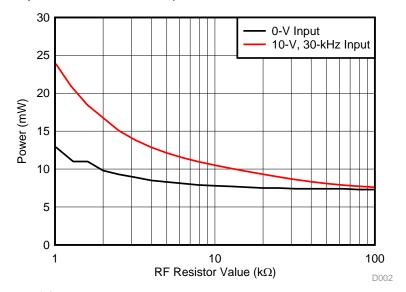
图 23. TIDA-01013 AFE Power versus R<sub>F</sub> Resistance
