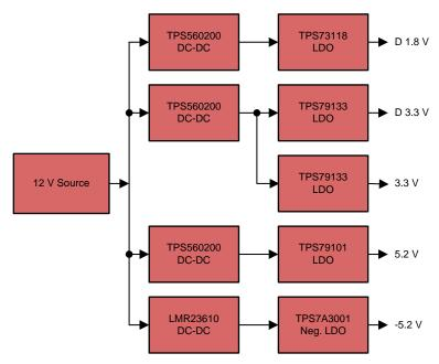
图 16. TIDA-01013 Power Supply Block Diagram
