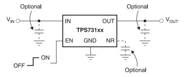
图 4. TPS73118 Typical Application Circuit
