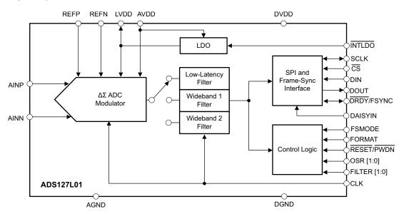
图 2. ADS127L01 Block Diagram
