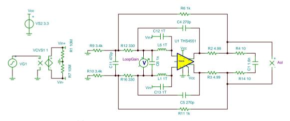
图 10. THS4551 TINA-TI Stability Schematic
