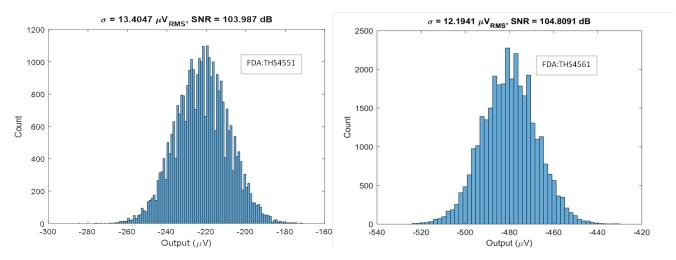
图 29. TIDA-01013 Noise Histogram for 0-V DC Input
