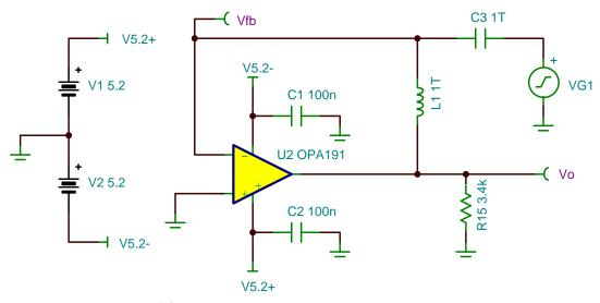
图 7. OPA191 TINA-TI Stability Schematic
