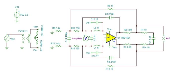
图 12. THS4561 TINA-TI Stability Schematic
