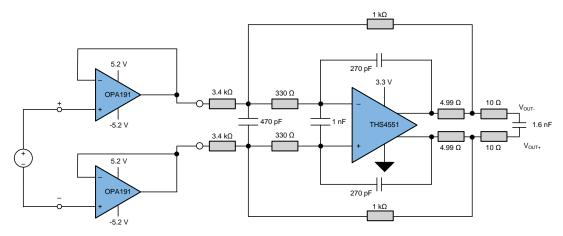
图 21. TIDA-01013 AFE Power Simulation Schematic
