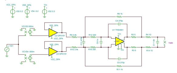
图 18. TIDA-01013 TINA-TI AFE Schematic
