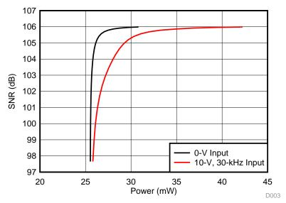
图 24. TIDA-01013 System SNR versus Power Plot
