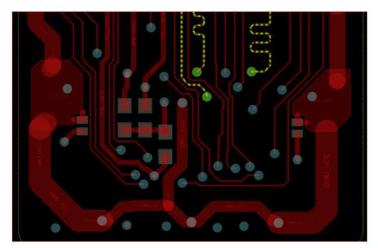
图 13. DMD Flex Cable—Bottom Layer
