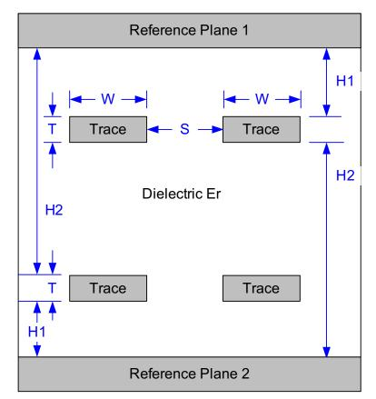
图 11. PCB Stacking Geometries
