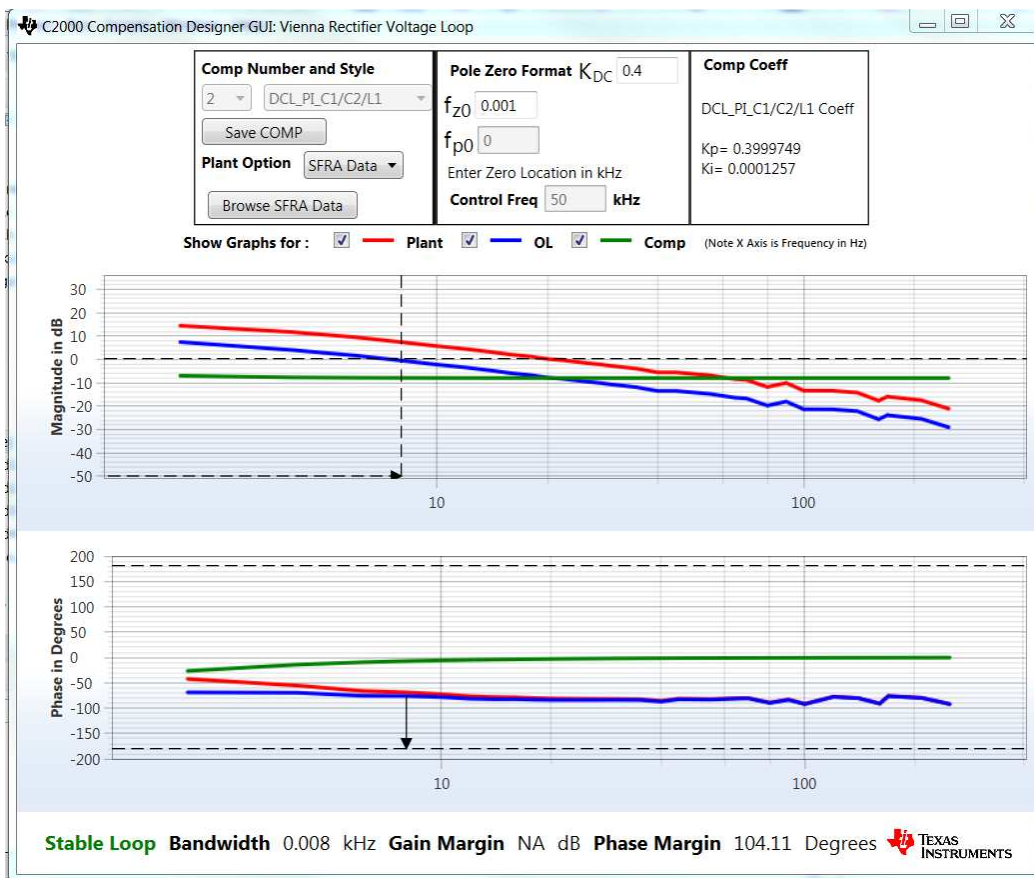
图 43. 使用测量的受控体信息设计的电压环路补偿
