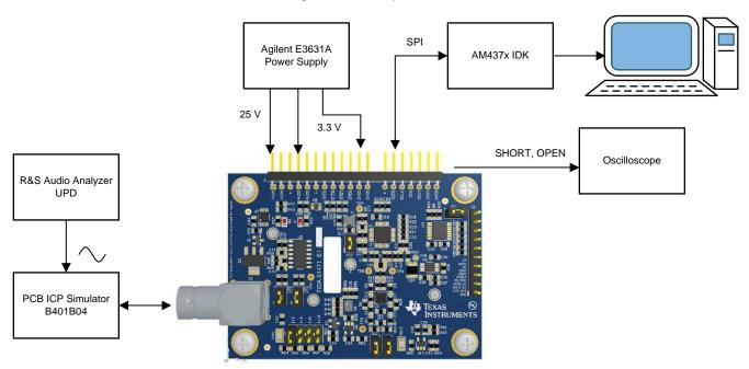
图 20. TIDA-01471 Test Setup
