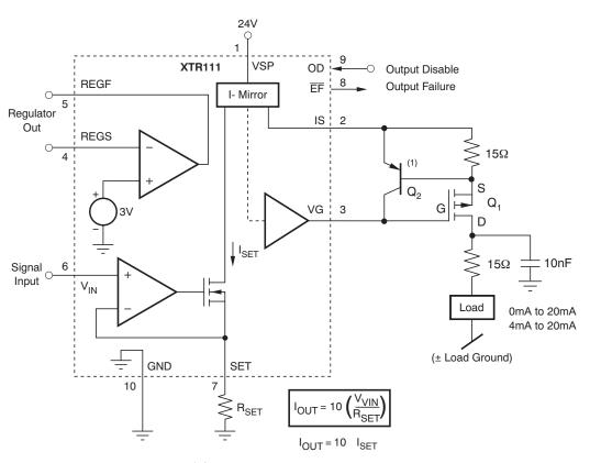
图 5. XTR111 Block Diagram
