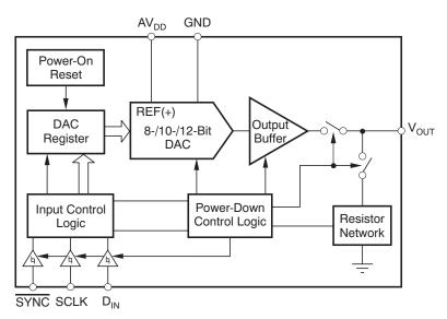
图 6. DAC5311 Block Diagram
