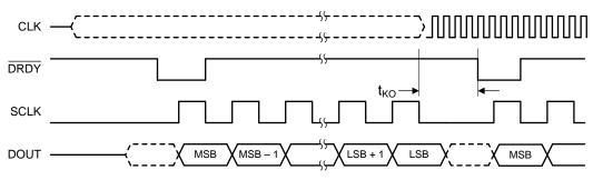
图 8. Example SPI Waveform for ADS127L01
