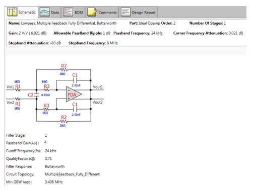
图 9. Filter Design Using TI FilterPro™ Tool
