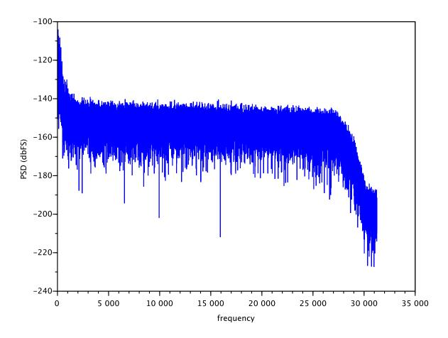
图 27. Noise Floor With XTR111 Enabled
