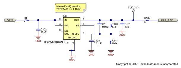
图 36. 3.3-V V<sub>DDOUT</sub> Generation for CDCE937
