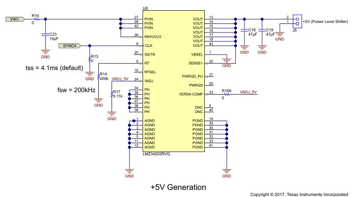
图 31. –5-V Generation Using LMZ34002
