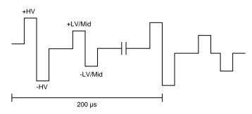
图 7. Five-Level Pulser Output Waveform
