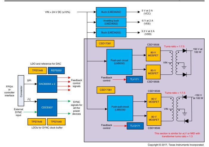
图 1. System Block Diagram for TIDA-01352
