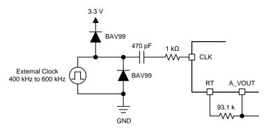
图 33. CLK Configuration (500-kHz Typ)
