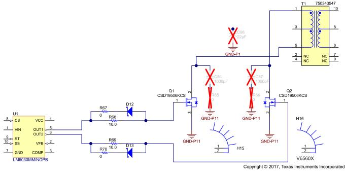
图 10. LM5030 Driving MOSFETs
