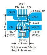
图 9. Recommended PCB Layout
