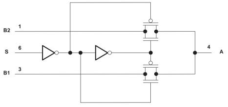
图 4. Logic Diagram (Positive Logic)
