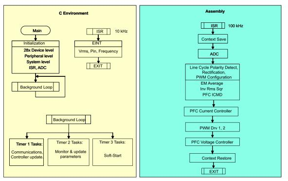
图 4. IL PFC Software Flow Diagram
