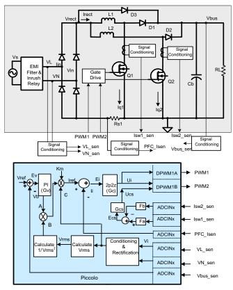
图 1. 采用 C2000 微控制器的交错式 PFC 转换器控制
