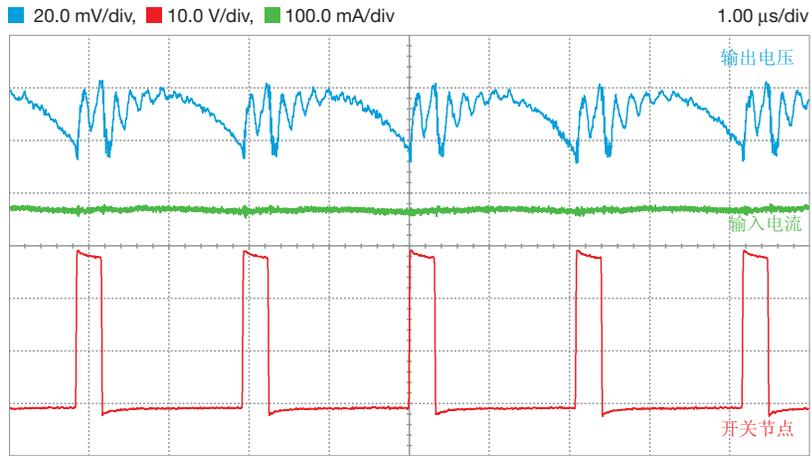
图 7.  $V_{in}=24V$ ,  $I_{out}=0.4A$ ,  $f_s=500kHz$ ,  $C_{out}=10\mu F$  (陶瓷电容)
