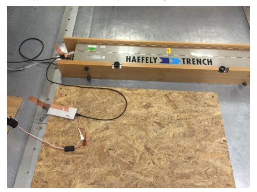
图 73. IEC 61000-4-4 EFT Test Setup
