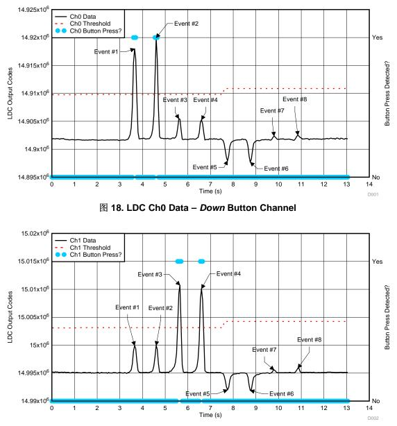
图 19. LDC Ch1 Data—Up Button Channel
