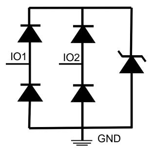
图 12. TPD2E2U06 Functional Block Diagram
