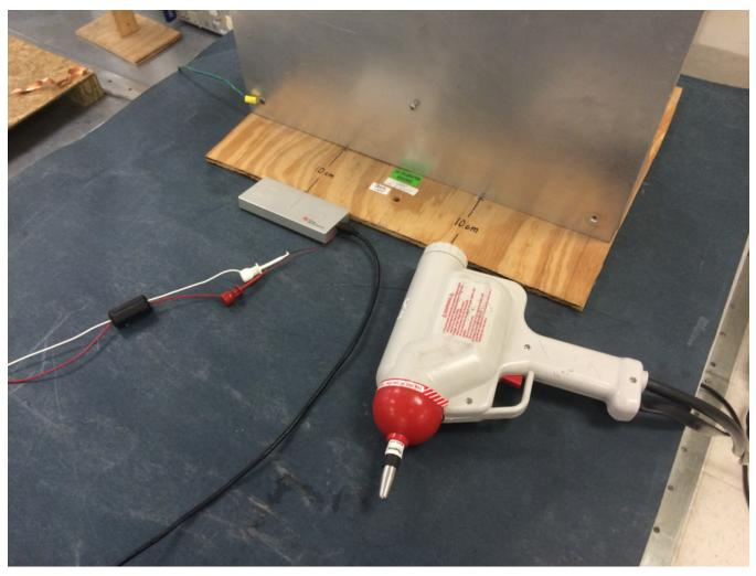
图 54. IEC 61000-4-2 ESD Test Setup
