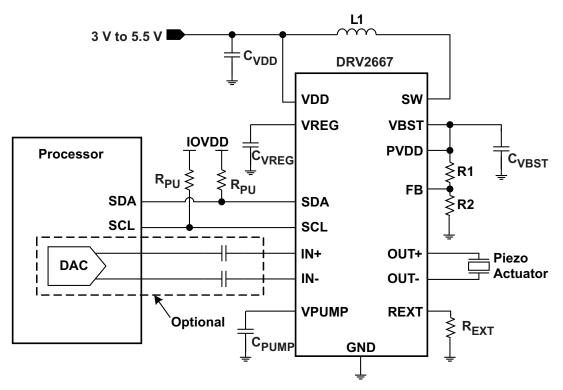
图 7. DRV2667 System Diagram
